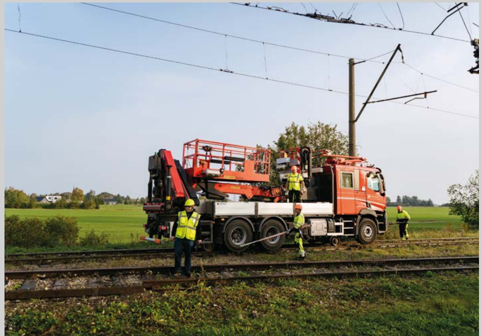
Pilt 33 Juhtratastega eriveerem, mis on seadistatud elektrifitseeritud raudtee kontaktvõrgu töödeks
