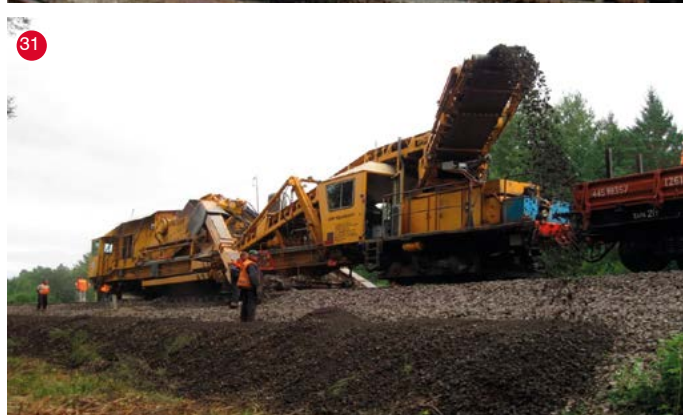
Pilt 30 Ballastiplaneerijat saab talvel kasutada lume lükkamisel või töös lumefreesiga
