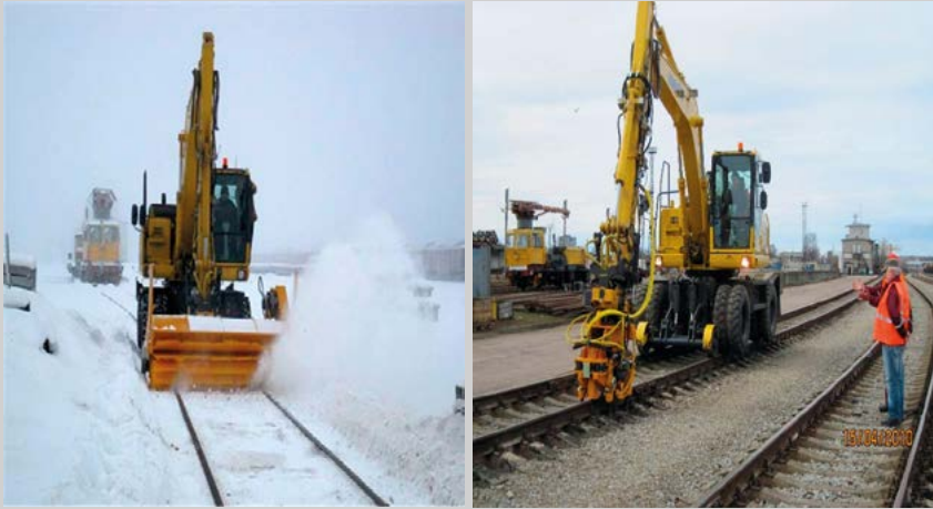
Pilt 32 Juhtratastega ekskavaator lumeharja ja liipri topperiga
