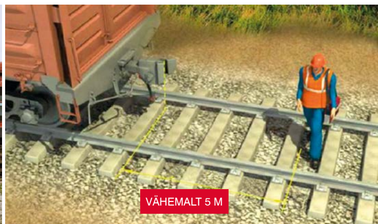
Pilt 53 Seisva raudteeveeremi eest ohutu läbimine
